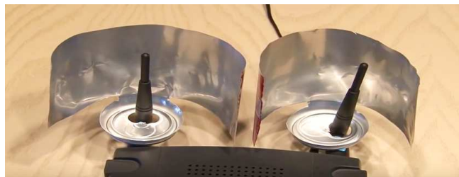
Hình 2. Chế tác dụng cụ hỗ trợ phát sóng wifi từ khuôn nhôm cắt thạch rau câu hay các vỏ lon bia.
